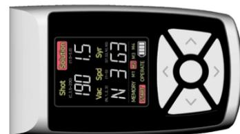
Interface de paramétrage placée sur la tête du dispositif.
